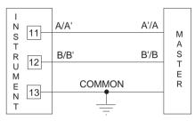
Fig. 11 - RS-485 WIRING
